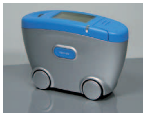
Bild 6: Das neue Messgerät, mit dem sich die Wolkigkeit objektiv kontrollieren lässt
