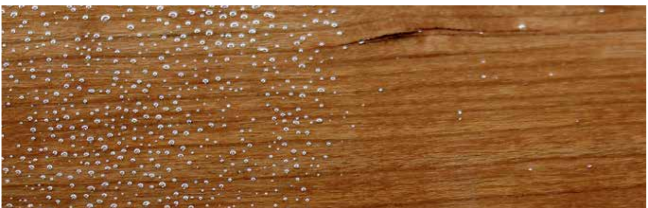
BYK-1799 的消泡性能(右图), 添加量 0.05%(基于整个涂料配方), 对比不加消泡剂(左图)的 100% UV 固化透明涂料体系, 使用泡沫滚筒辊涂施工。
