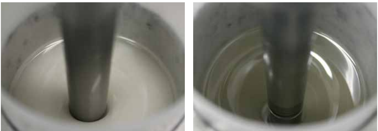
无溶剂聚氨酯丙烯酸酯涂料体系生产过程中的自发消泡 (左图: 不加消泡剂; 右图: 0.3% BYK-1788, 基于整个涂料配方)。
