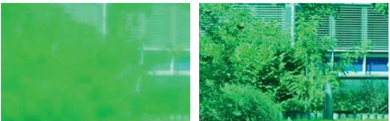
选择合适的润湿分散剂使一个含有酞菁颜料的涂料体系展现出优秀的透明性(右图)与之相反,颜料稳定不充分的涂料透明性较差。(左图)
