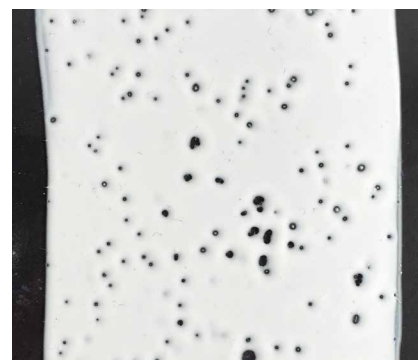
Плохое смачивание поверхности формы из-за высокого коэффициента поверхностного натяжения гелькоута
