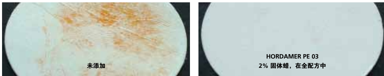
测试体系：水性丙烯酸罩光油墨，24 小时干燥后；测试仪器：耐磨测试仪（Prüfbau），250 次往复擦拭；水性胶印罩光油墨
