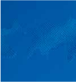
Schlechte Untergrundbenetzung eines Wasserlacks auf PVC-Folie
