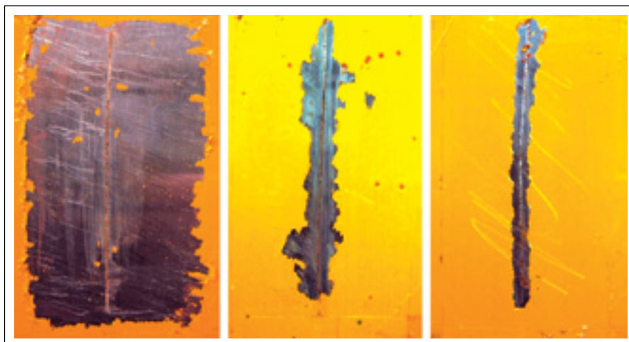
Abb. 4: Haftvermittlertest für 2K-PU
