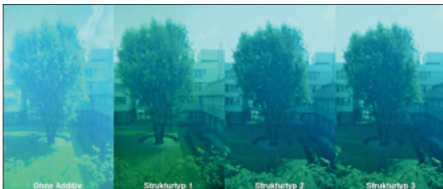
Abb. 5: Einfluss der Strukturtypen auf die Transparenz des pigmentierten 2K-Polyurethan-Systems (OH-funktionelles Acrylat/rein aliphatisches Polyisocyanat) am Beispiel von P.G. 7
