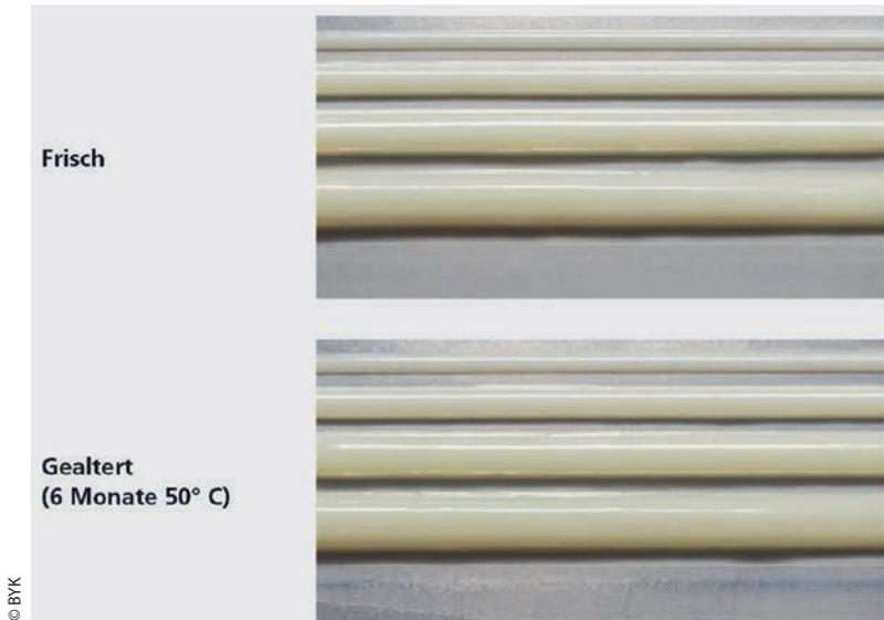
**Bild 10** > Auftrag unterschiedlicher Schichtstärken direkt nach Herstellung und nach Lagerung
