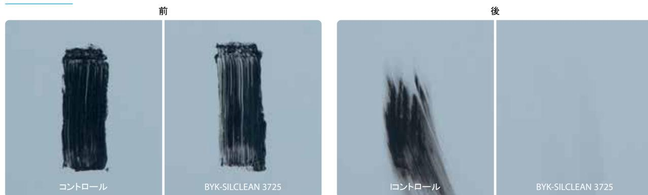
試験系: アルミニウムパネルに HVLV スプレーで塗布した水性アクリルメラミンクリアコート
