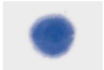
2 ml 水在 1 分钟后 使用不含有有机硅稳定剂 BYK-8070 (亲水性)
