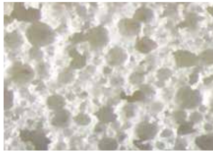
使用有机硅稳定剂 BYK-8020 的机械发泡泡沫
